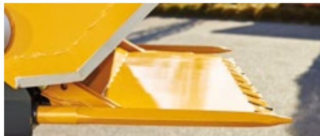
Každý vykusovač jde jednoduše kdykoliv dovybavit díky šroubovanému způsobu uchycení dodatečné výbavy. Například na obrázku je vidět sklopné kukuřičné dno, které zabraňuje ztrátám krmení při vykusování jemné kukuřičné siláže.
