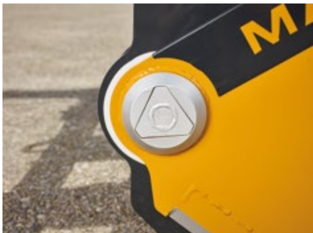
Obrovský průměr hlavního ložiska (typ N,M: 50 mm / typ H,XL: 60 mm) garantují dlouhou životnost vykusovače.
